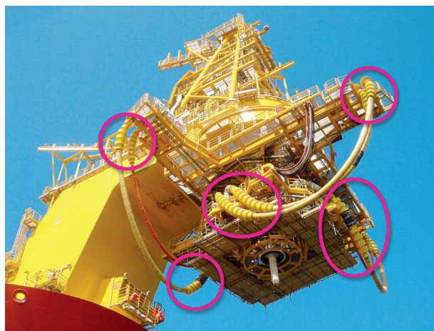
Abbildung 15. Verlaeschläuche mit Leitungs- und Knickschutzelementen (markiert) aus PU-Elastomeren auf einem Offshore-Ladekran.
