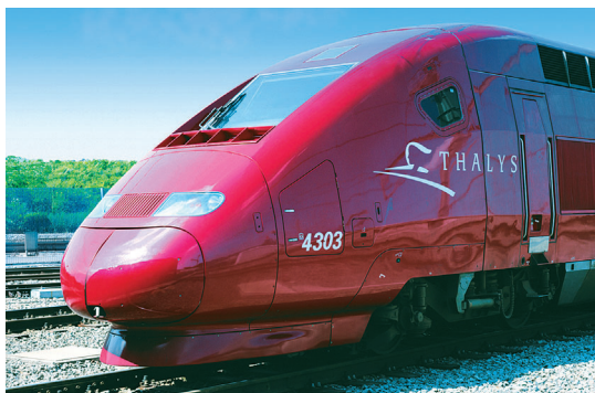
Abbildung 20. Hochwertige wässrige 2K-Polyurethandecklacke sind Stand der Technik bei der Lackierung von Personenzügen.
